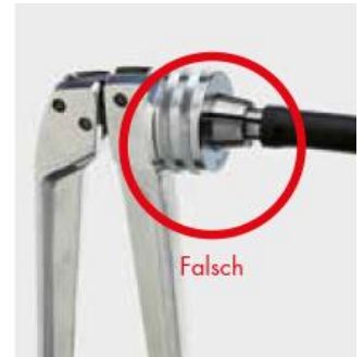
Rohr nicht vollständig auf Aufweitkopf aufgesteckt
