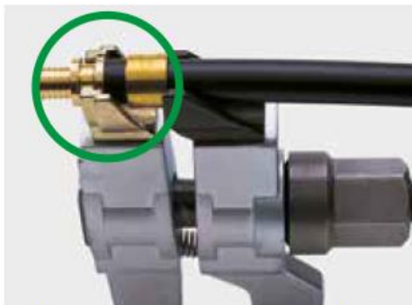
Richtig ausgerichtet in MSZ Schiebebacke F.
