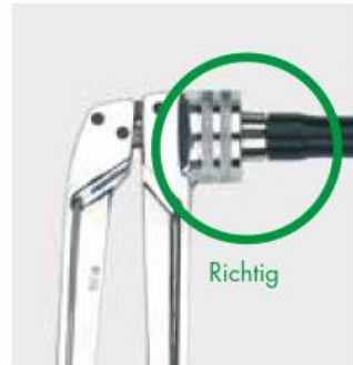
Rohr vollständig auf Aufweitkopf aufgesteckt
