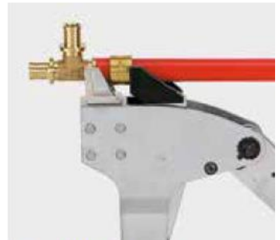
Manueller Aufschiebevorgang mit KSZ.
