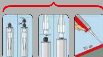
Mörtelvorlauf verwerfen (bis der Mörtel eine einheitliche Farbe aufweist - ca. 10 cm)
