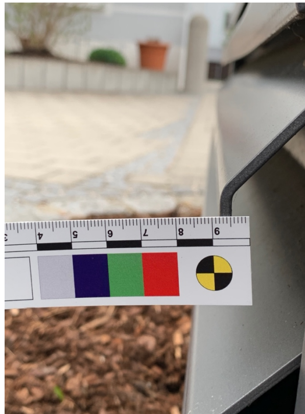
Abb. 17: Bsp.: Materialstärke 3 mm
