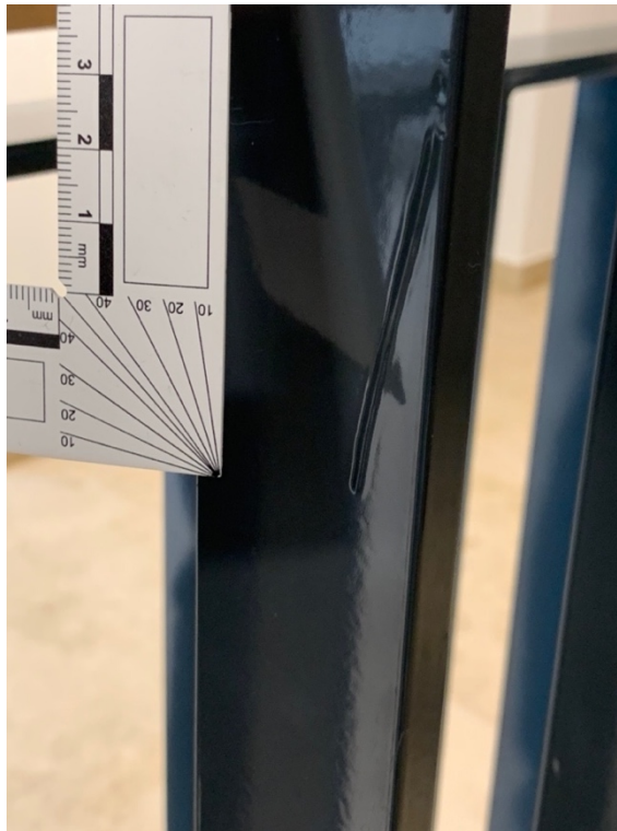
Abb. 31: Mangelhafte Oberfläche
