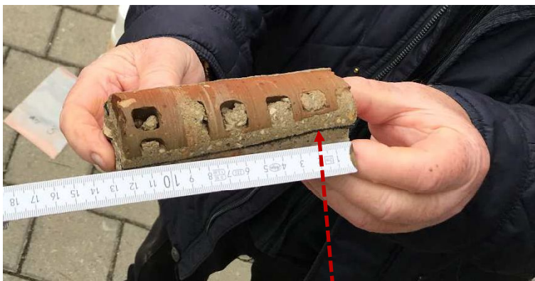
Abb. 12: Bohrkern Südfassade.
