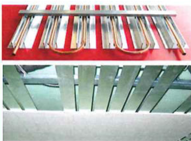
Nahaufnahme eines Mäander- elements vor und während der Montage im Prüfraum
