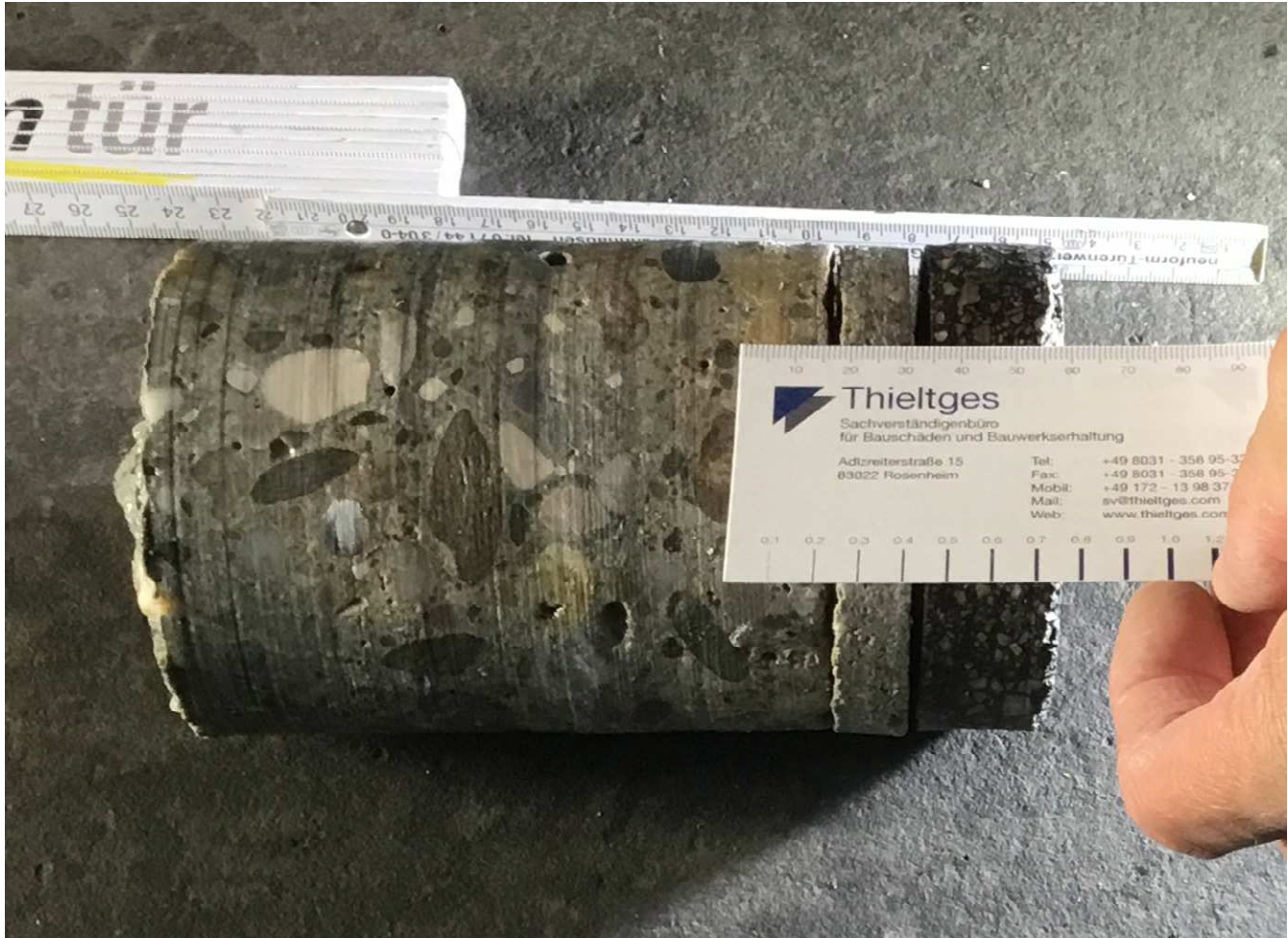
Abb. 30: Bohrkern BK 02. Der Bohrkern DN 100 mm konnte bis zu einer Tiefe von ca. 14 cm entnommen werden (siehe Abb. 14).
