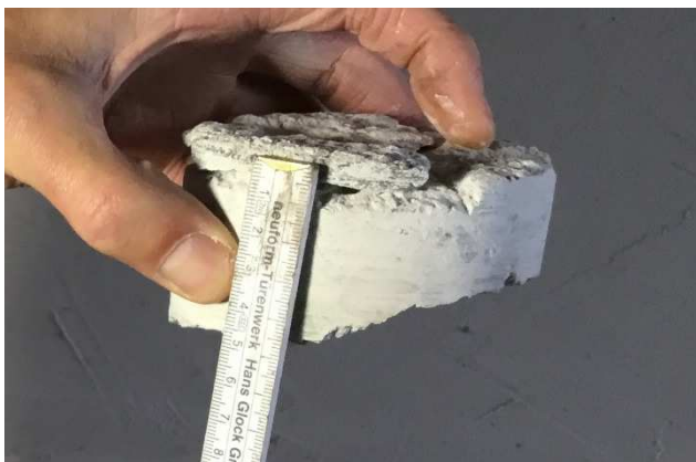
Abb. 31: Bohrkern BK 01. Die Bohrkernentnahme DN 100 mm in der Rampe wurde bei einer Tiefe von ca. 4 cm abgebrochen.
