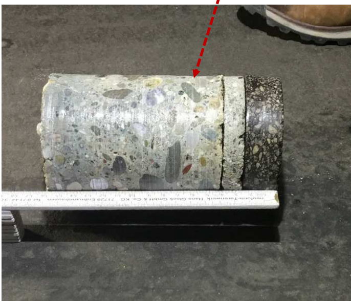
Abb. 13: Bauteilöffnung Nr. 34 [A] 6 am Tiefgaragenboden neben der Rinne. Der Tiefgaragenboden ist durchgehend mit einem Gussasphaltbelag belegt. Unter dem Gussasphalt befindet sich ein Estrich der im Gefälle zur Entwässerungsrinne (Tiefpunkt) verlegt ist.
